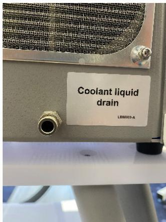
Ouvrir complètement le Coolant Liquid Drain et placez un bac de récupération dessous pour récupérer l'eau
