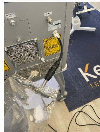
Insérez le tube dans le Coolant Liquid Fill et pressez sur la poche jusqu'à ce que l'eau ressorte par le trop plein blanc et que le réservoir soit rempli
